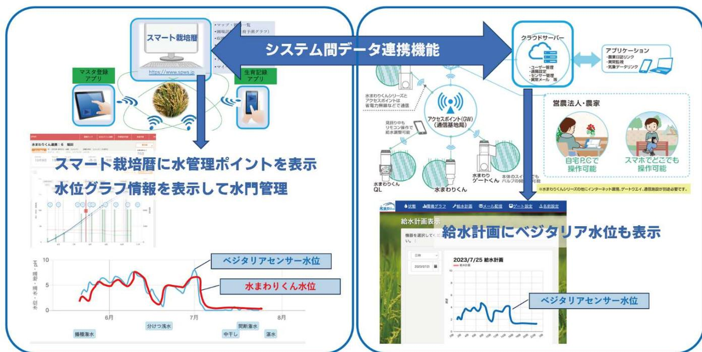
また、スマート栽培暦®は、国の J-クレジット制度における新たな方法論として承認された「水稲栽培における中干し期間の延長」にも対応し、品種・地域ごとの適切なタイミングに中干しを開始し、中干し期間中の稲の生育をモニタリングしながら収量や品質への影響を最小化しつつ中干しを延長することができます。今回の水まわりくんとの連携により、J-クレジット申請に必要な中干しの核となる水管理を自動給水栓による厳密な開閉制御で実現し、水稲栽培のデータを参照しつつ、リスクのない適切な中干し実施のエビデンスとしてデータを蓄積できるように、安全な中干し実施へのさらなる認知拡大を目指します。
